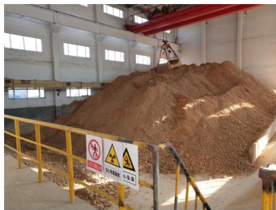
图 4-31 水浸渣库内废渣
